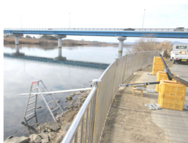
雨どいを改造した放流装置
